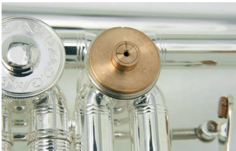
Erst bei abgeschraubtem Ventildeckel wird sie sichtbar: Die Schmierrille (serienmäßig bei allen Ricco-Kühn Trompeten)
